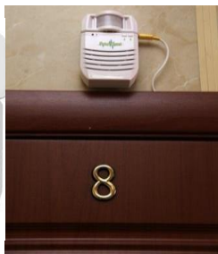
Звуковой маяк с резервным питанием и датчиком движения
