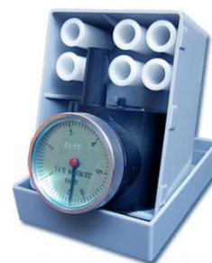
**Динамометр** - прибор для измерения силы или момента силы, состоит из силового звена (упругого элемента) и отсчётного устройства. В силовом звене измеряемое усилие вызывает деформацию, которая непосредственно или через передачу сообщается отсчётному устройству.
