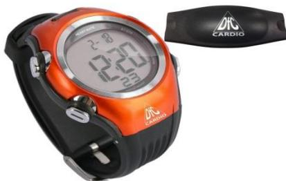
**Пульсомер**, или монитор сердечного ритма — устройство персонального мониторинга частоты сокращений сердца в реальном времени или записи его для последующего исследования.
