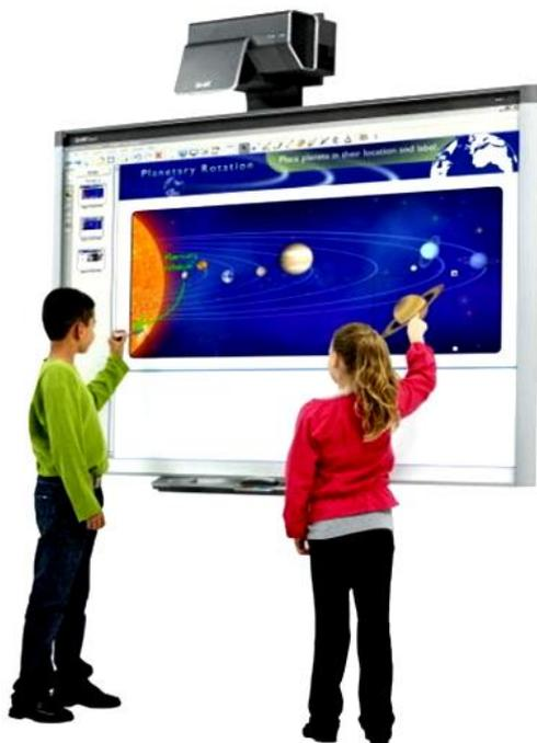
На интерактивной доске можно работать так же, как с дисплеем компьютера: это устройство ввода данных, которое позволяет контролировать приложения на компьютере. Если какая-либо программа открыта на компьютере, вы можете работать с ней прямо на интерактивной доске.
